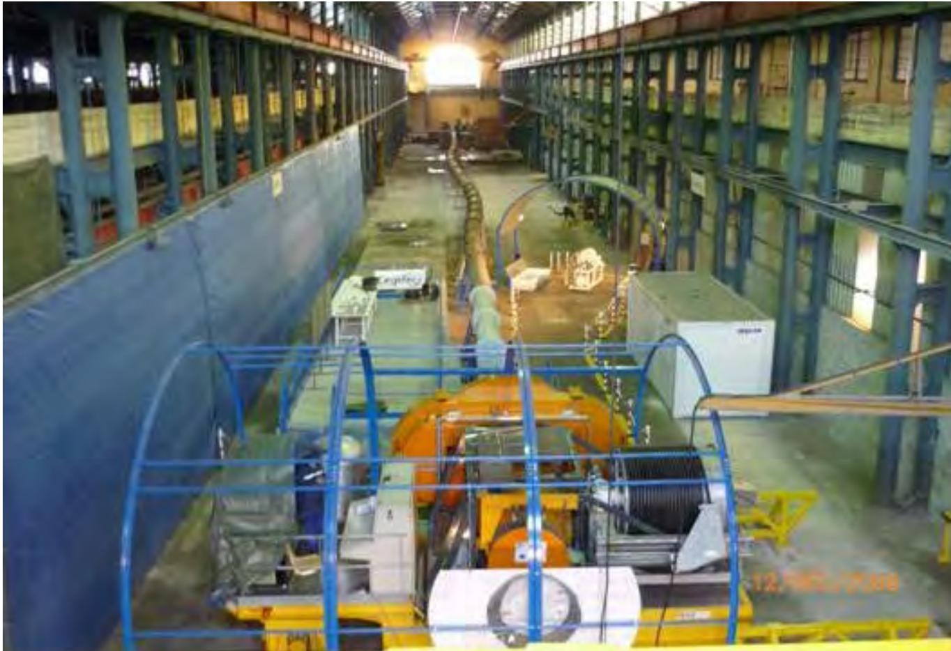
**Test de manutention de colis HA avec simulation de grandes déformations de l'alvéole**
