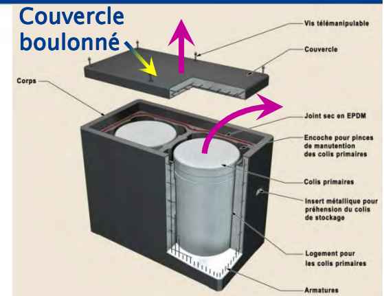
Principe de désassemblage de colis de stockage MAVL avant transport vers un autre site
