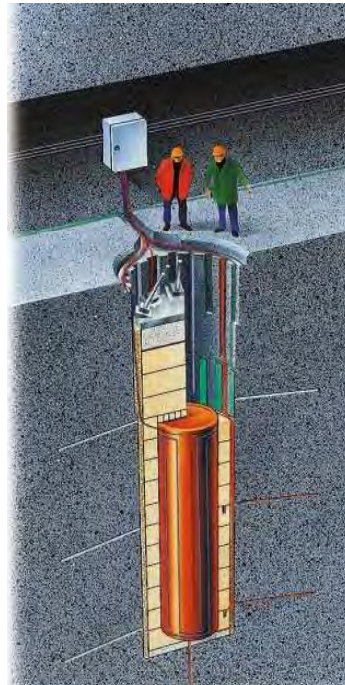
Essai de dépose des anneaux de bentonite en vue de la récupération de colis de déchets* en Suède (Äspö HRL, 2006)
