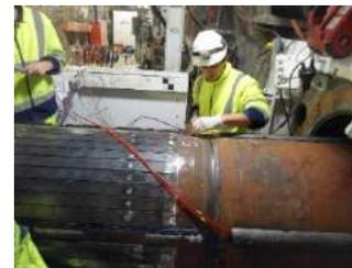
*Chemise équipée de fibres optiques pour mesure de  $\epsilon_{90}$*
