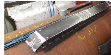
*Système de protection des capteurs géochimiques*
