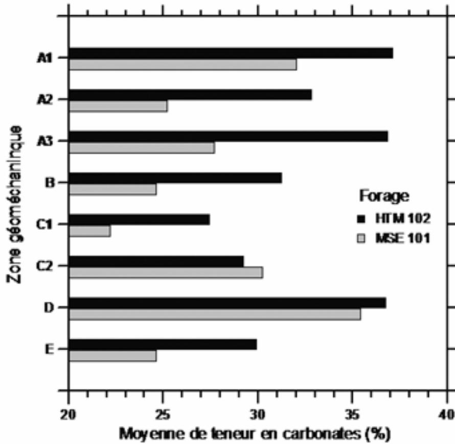
Figure 5-1 Variabilité verticale de la teneur en carbonates du Callovo-Oxfordien à deux endroits de forage sur le site de Bure en fonction des valeurs moyennes pour les zones hydromécaniques. Données du Référentiel Géologique, Tome 4, tableau 2.1-02.
