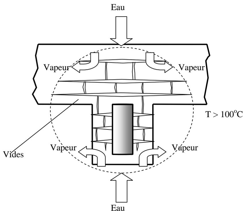
Figure 2. Vides de construction dans le remblayage sec
