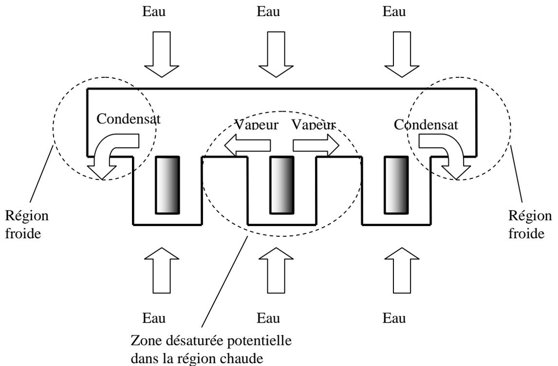
Figure 3-1. Schéma conceptuel des circulations des condensats eau-vapeur dans un système, fermé à température variable
