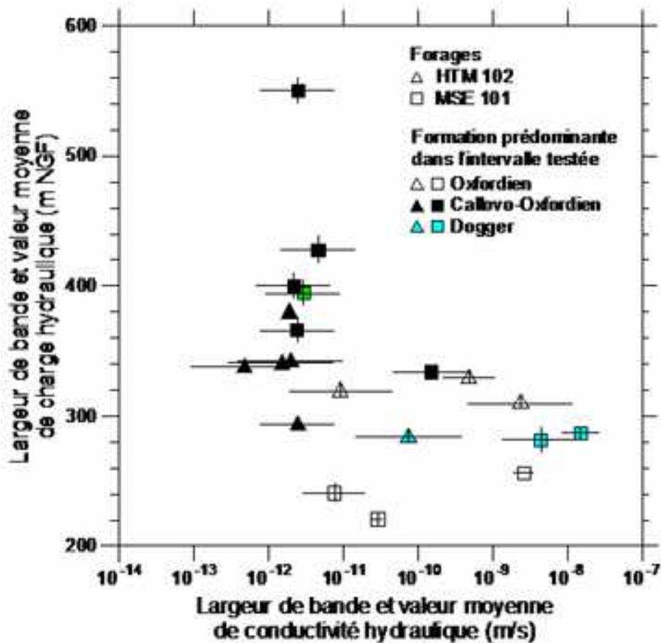
Figure 5-4 Dépendance de la pression hydraulique vis-à-vis de la conductivité hydraulique dans le Callovo-Oxfordien et les calcaires sous- et sus-jacents du Dogger et de l'Oxfordien.
