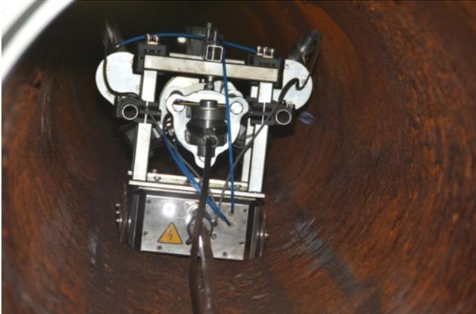
Réalisation d'un banc d'essai en surface pour tester le retrait de colis HA dans un tubage fortement corrodé
