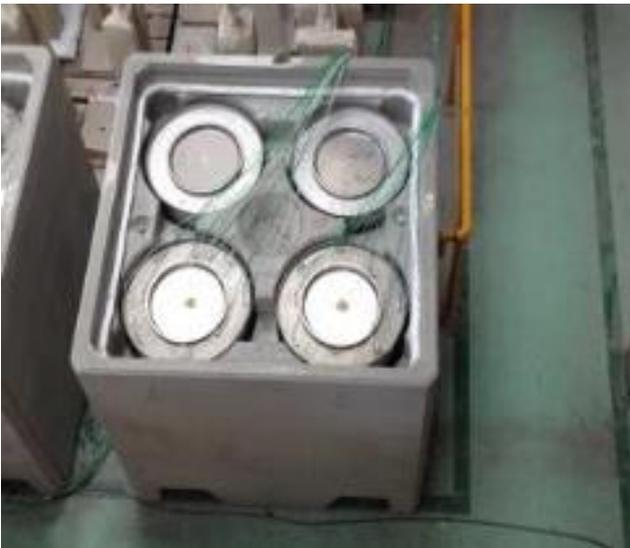
Essais réalisés avec des fûts d'enrobés bitumineux représentatifs des déchets bitumes produits à Marcoule et La Hague
