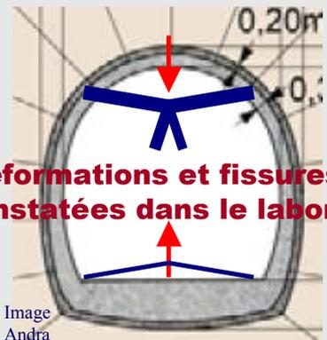
**Déformations et fissures déjà constatées dans le laboratoire**
