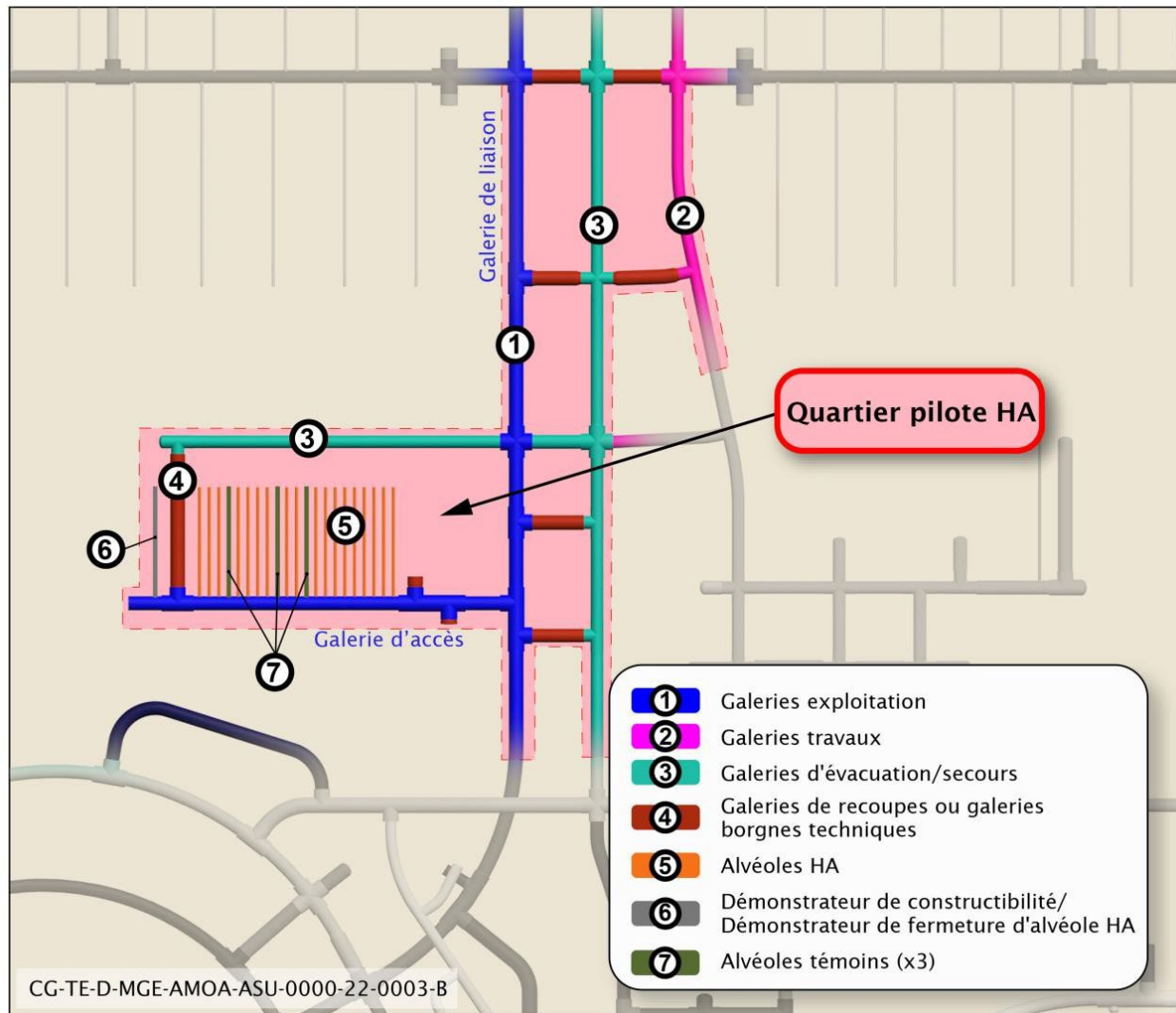
Figure VI-2 : Plan d'architecture des ouvrages souterrains montrant : le Quartier pilote HA et les éléments de construction qui lui sont associés, la zone de stockage HA lors de la Phipil
